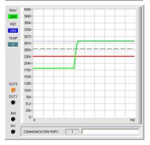
Wird der aktuelle Messwert **RAW** (grüne Linie) wieder größer als die Hystereseschwelle (schwarze Linie), dann wird auch der Ausgang **OUT0** wieder +24V (Signal ist in Ordnung). Dies wird über die LED **OUT0** visualisiert
